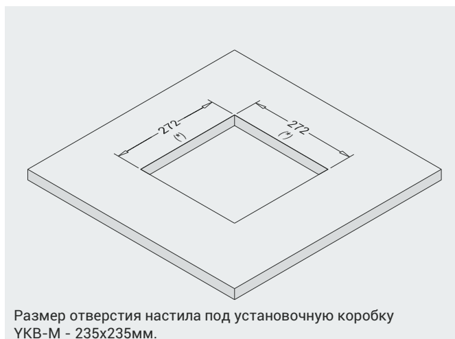
DKY Размеры отверстия в настиле фальшпола (мм)
