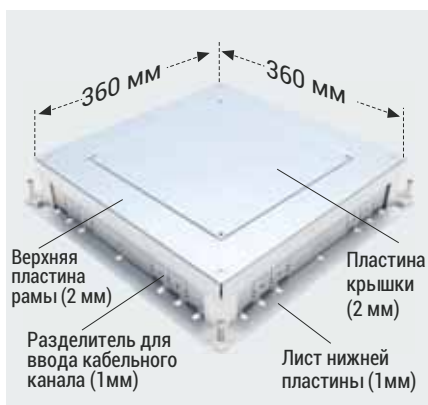
Ответвительный узел DKN-SK
