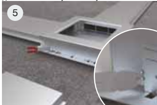
5 Отрежьте лист для изготовления сепаратора в соответствии с размером лотка.
