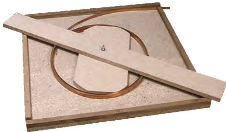
Кассета для соединения проводников ТВ
