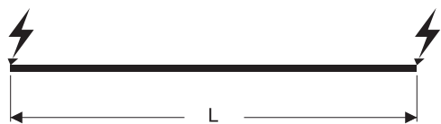
2 подвода питания с торцов L_t=L/4
