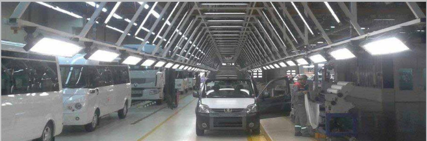
**Финишные линии:** Линия последнего контроля качества окраски автомобиля на заводах производства автомобилей. Ввиду вероятного наличия дефектов окраски автомобилей, требуется проведение тщательного завершающего контроля.
