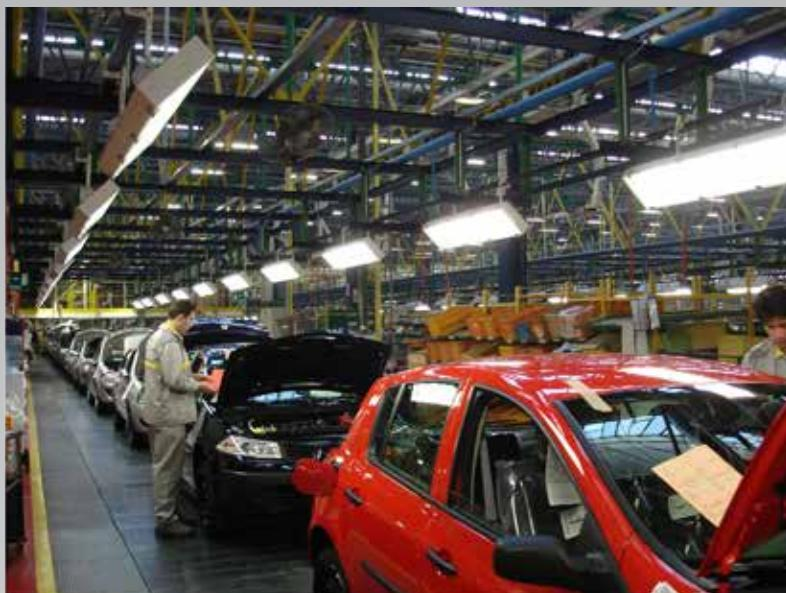
**REVO-Zebra:** Созданы для применения на финишных линиях и в производственных помещениях автомобильной промышленности. Серия светильников длительного срока службы с контролем ослепления
