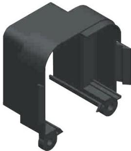
Изготовлен из изолирующего пластика для защиты и изоляции соединения медных проводников. Поставляется собранным на секции троллея, по одной половинке на каждом конце. При монтаже две половинки сдвигаются и защёлкиваются. Для достижения повышенной надежности рекомендуется усилить соединение двумя болтами с гайками.
