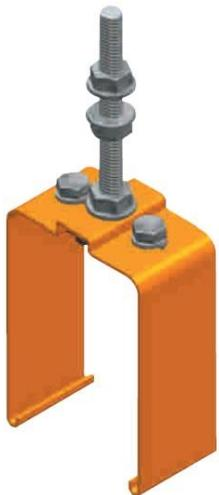
Поскольку троллей подвешен на скользящих подвесах для компенсации температурных расширений, необходимо зафиксировать систему около ввода питания фиксирующим подвесом. Изготовлен из оцинкованной стали и окрашен эпоксидной краской оранжевого цвета (RAL 2004). При монтаже зафиксировать корпус троллея двумя болтами M6. Вес 168 г.
