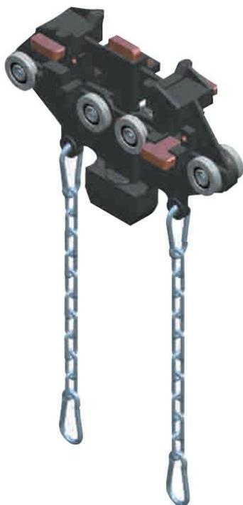
Корпус изготовлен из диэлектрического пластика и четыре щётки из металлографита N-Si, пружины из нерж. стали AISI302. Металлические колёса с шарикоподшипниками. Чтобы избежать ошибки включения фаз
