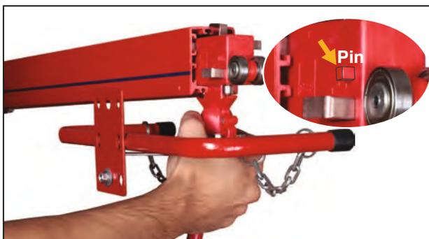
Необходимо добиться соосности центровочного штифта и отверстия в корпусе, благодаря этому тележка будет установлена правильно.
