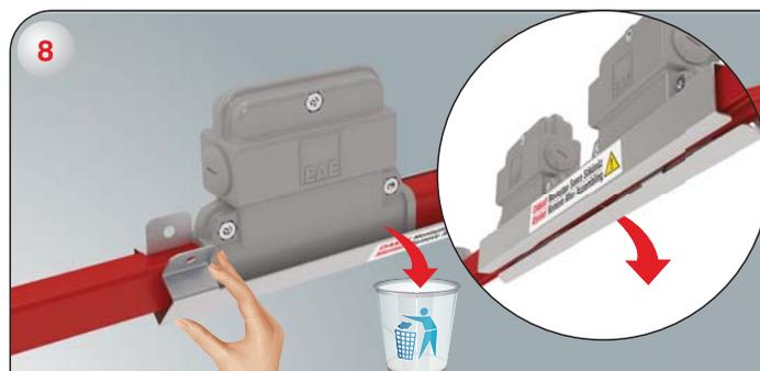
8-) Пластины выравнивающей планки выбросьте в утилизационный ящик.
