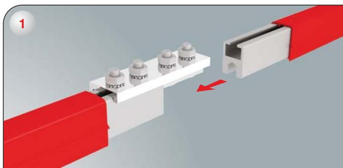
1-) Контактную планку соединителя, соединяющую две секции алюминиевого моноблочья, установите между токоведущими шинами (алюминиевыми проводниками) так, чтобы гайки контактной планки находились сверху.
