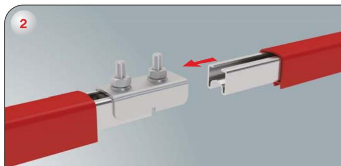
2-) Контактную планку соединителя, соединяющую две секции стального монотролля, установите между токоведущими шинами (стальными проводниками) так, чтобы гайки контактной планки находились сверху.
