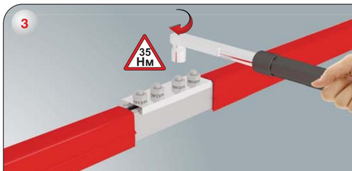
3-) Снимите монтажную линейку и затяните гайки динамометрическим ключом до момента 35Нм.
