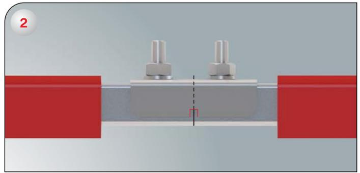
2-) Установите монтажную линейку так, чтобы она охватывала контактную планку соединителя с двух сторон и чтобы метка «^» приходилась точно по середине стыка двух секций.
