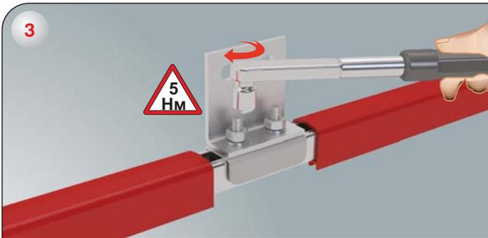
3-) Снимите монтажную линейку и затяните гайки динамометрическим ключом до момента 5 Нм.
