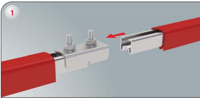
1-) Контактную планку соединителя, соединяющую две секции стального моноотрелля, установите между токоведущими шинами (стальными проводниками) так, чтобы гайки контактной планки находились сверху.
