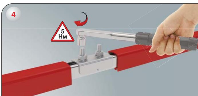
4-) Затяните гайки с помощью динамометрического ключа до момента 5 Нм.
