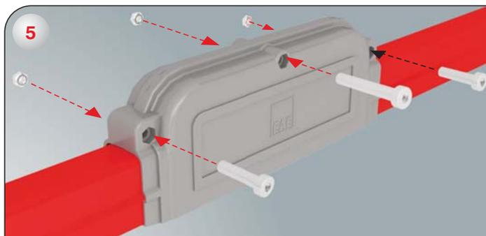
5-) Вставьте болты и гайки в соответствующие отверстия в крышках.
