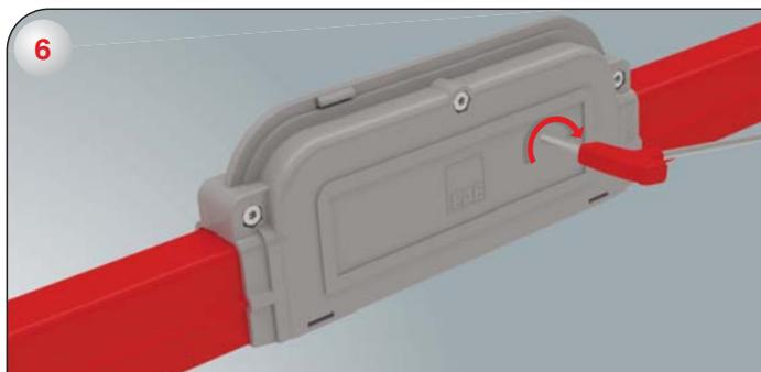
6-) Затяните болты при помощи специального ключа.
