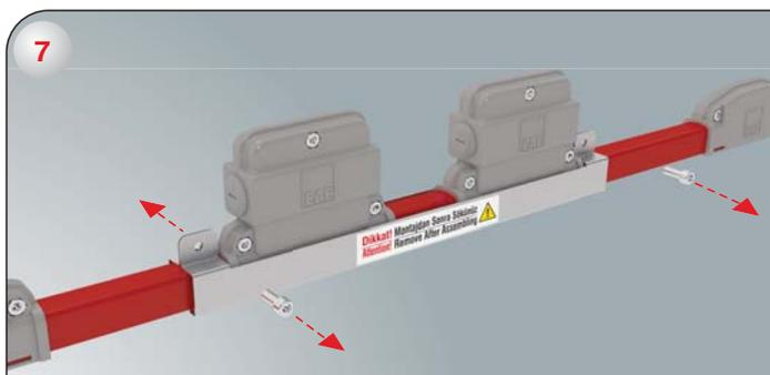
7-) Снимите болты пластины выравнивающей планки, находящейся на расширительном модуле.
