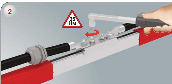
2-) Проводите кабели питающую систему через муфты и соедините к контактной планке с гайками далее скрутите с динамометрическим ключом 35 нх.
