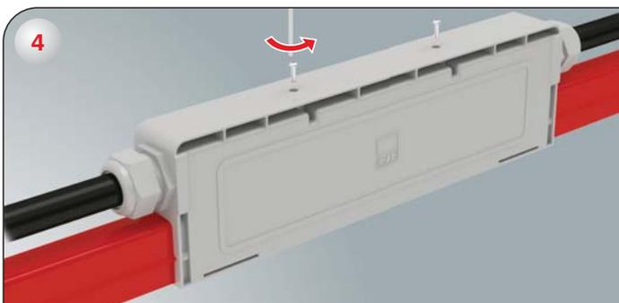
4-) Вставьте болты и гайки в соответствующие отверстия и затяните их при помощи ключа.
