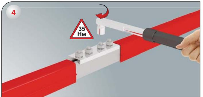
4-) Снимите монтажную линейку и затяните гайки динамометрическим ключом до момента 35Нм.
