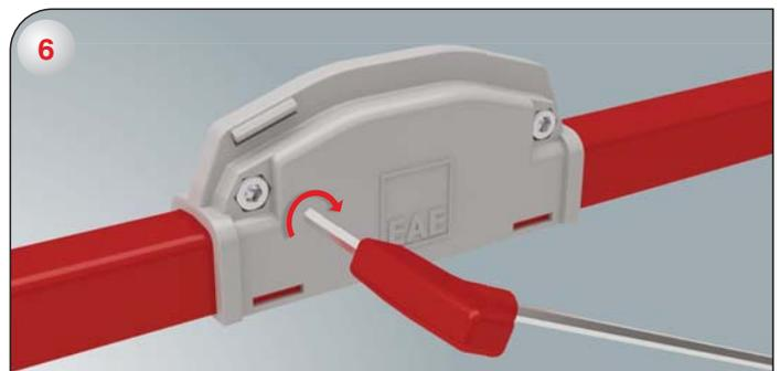
6-) Затяните болты при помощи специального ключа.
