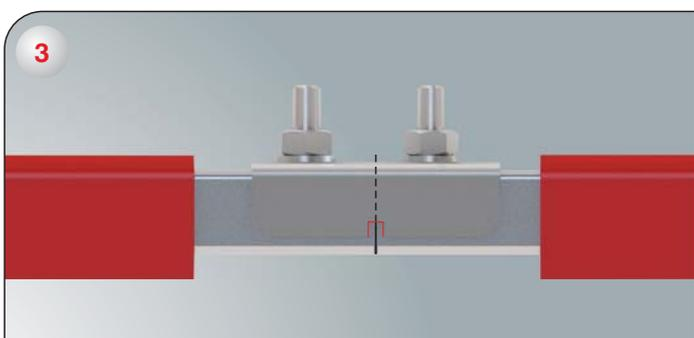
3-) Установите монтажную линейку так, чтобы она охватывала контактную планку соединителя с двух сторон и чтобы метка «^» приходилась точно по середине стыка двух секций.
