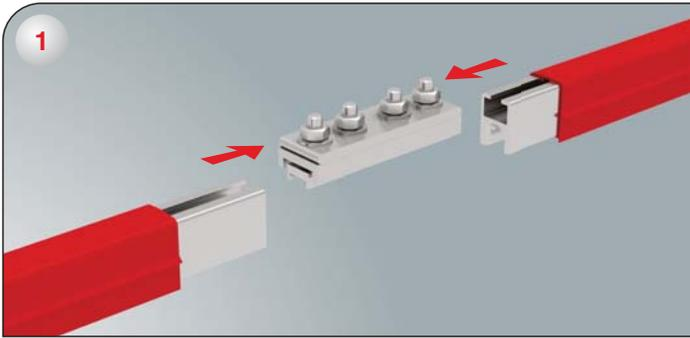
1-) Контактную планку соединителя, соединяющую две секции алюминиевого монотролля, установите между токоведущими шинами (алюминиевыми проводниками) так, чтобы гайки контактной планки находились сверху.
