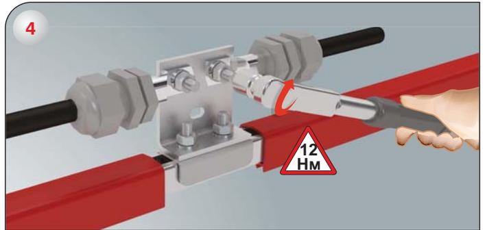
4-) Протяните питающие кабели через уплотнительные вводы и опрессуйте токонесущие жилы кабелей наконечниками, а затем установите их на контактную планку секции ввода питания с середины и затяните наконечники гайками с помощью динамометрического ключа до отметки 12 Нм.
