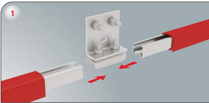
1-) Контактную планку соединителя, соединяющую две секции стального монопрофиля, установите между токоведущими шинами (стальными проводниками) так, чтобы гайки контактной планки находились сверху.
