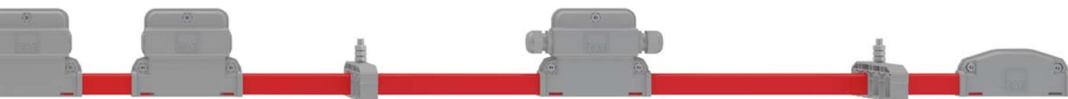
Между вводной секцией и другими элементами шинопровода необходимо оставить свободную зону минимум **300 мм**.
