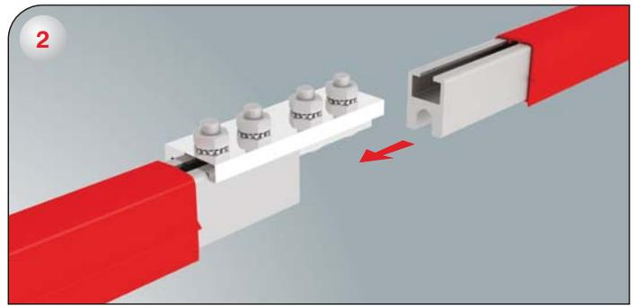
2-) Контактную планку соединителя, соединяющую две секции алюминиевого моноотрелля, установите между токоведущими шинами (алюминиевыми проводниками) так, чтобы гайки контактной планки находились сверху.
