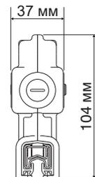
Секция компенсационная - защищающая систему от механических напряжений вызванных температурными колебаниями и устанавливается через каждые 100 метров трассы и на осадочных швах зданий, сооружений.
