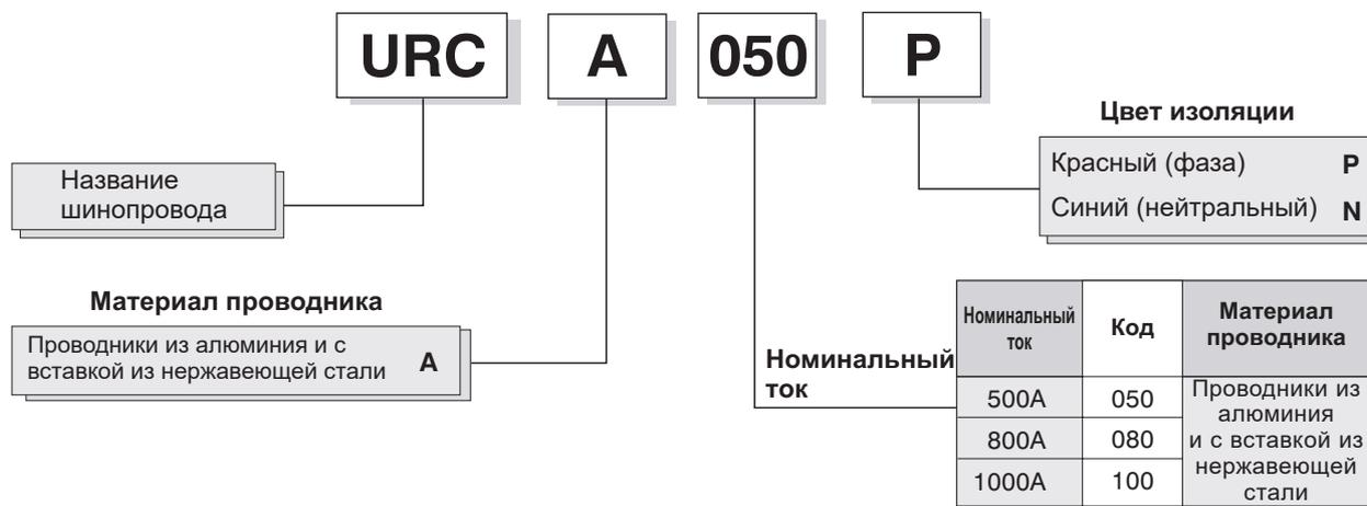
**Образец заказа:** URC с проводником из алюминия и нержавеющей стали, 500А, фаза, красная ПВХ изоляция
