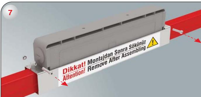
7-) Снимите болты пластины выравнивающей планки, находящейся на компенсационной секции.
