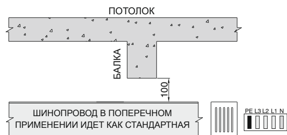
РИСУНОК 4 - ПЕРЕСЕЧЕНИЕ ПОД БАЛКОЙ А В ПОПЕРЕЧНОМ ПРИМЕНЕНИИ
