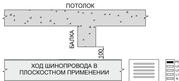
РИСУНОК 5 - ПЕРЕСЕЧЕНИЕ ПОД БАЛКОЙ А В ПЛОСКОСТНОМ ПРИМЕНЕНИИ
