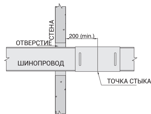
Рисунок 6. проход шинопровода через стену на горизонтальном участке
