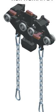
Корпус изготовлен из диэлектрического пластика и четыре щётки из металографита N-Si, пружины из нерж. стали AISI302. Металлические колёса с шарикоподшипниками.
