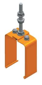
Поскольку троллей подвешен на скользящих подвесах для компенсации температурных расширений, необходимо зафиксировать систему около ввода питания фиксирующим подвесом. оцинкованной Изготовлен ИЗ стали окрашен эпоксидной краской оранжевого 2004). (RAL При можтаже зафиксировать корпус троллея двумя болтами М6. Вес 168 г.
