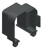
Изготовлен из изолирующего пластика для защиты и изоляции соединения медных проводников. Поставляется собранным на секции троллея, по одной половинке на каждом конце. При монтаже две половинки сдвигаются и защёлкиваются. Для достижения повышенной надежности рекомендуется усилить соединение двумя болтами с гайками.
